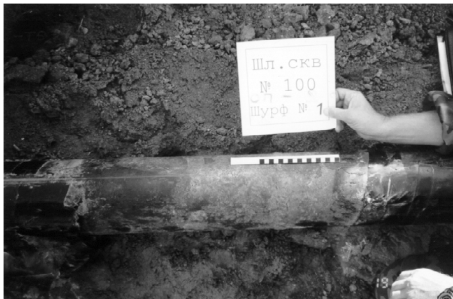
Рис.1. Внешний вид повреждения изоляции и коррозионного состояния металла трубы в шурфе, подготовленном по результатам электрометрических измерений
